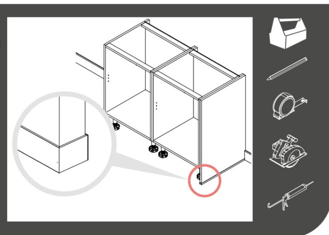
**I** Kürzen Sie die Wange mit einer Kreissäge um 6 mm ein.
