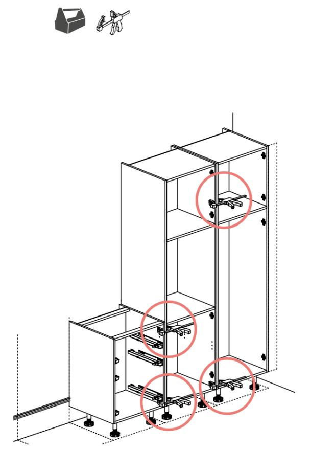
**8** Befestigen Sie die Elemente mit Hilfe von Schraubzwingen aneinander.
