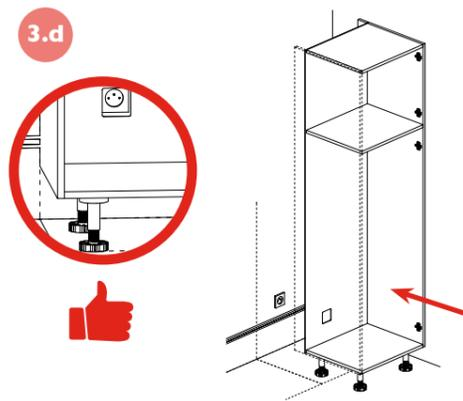
**Experten-Tipp** Es wird empfohlen, die für Elektrogeräte vorgesehenen Steckdosen zugänglich zu lassen und im benachbarten Korpus zu platzieren. Ein defektes Elektrogerät muss rasch ausgesteckt werden können.
