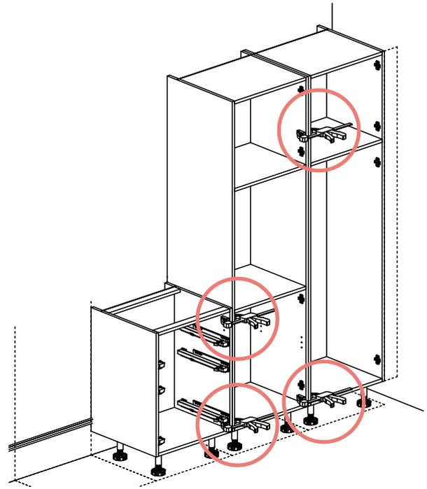
**8** Fije los elementos entre ellos utilizando una abrazadera.
