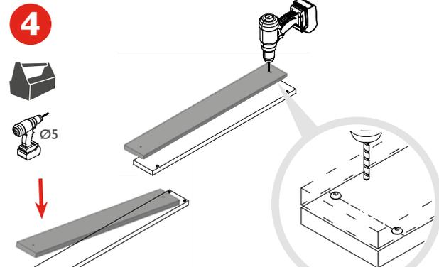
AJUSTE DE LA REGLETA DE FRENTE (alineada con la parte delantera del frente).
