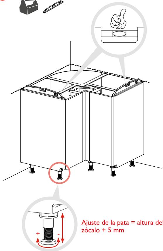
Ajuste de la pata = altura del zócalo + 5 mm
