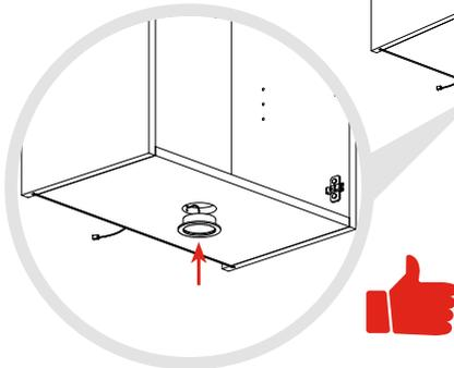
**4** Fije el mueble alto y conecte el punto de luz al transformador.
