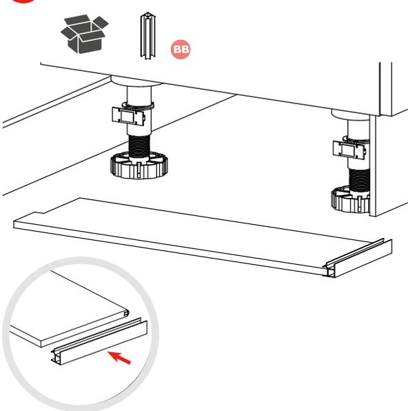
**11** Limpie la vuelta de zócalo y retire la protección de cinta adhesiva.
